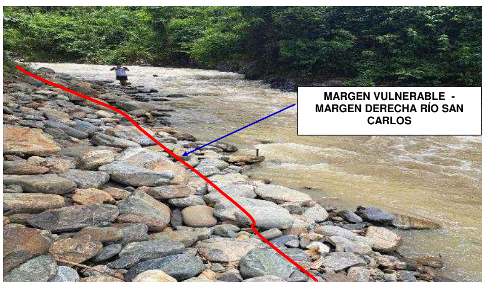
FIGURA N°01: TRAMO CRÍTICO EN EL RÍO SAN CARLOS , EN EL SECTOR POCHOTENI, DISTRITO DE CIELO PUNCO, PROVINCIA DE LA CONVENCION - CUSCO. MATERIAL DE BOLONERÍA EN EL TALUD DEL RÍO SAN CARLOS
